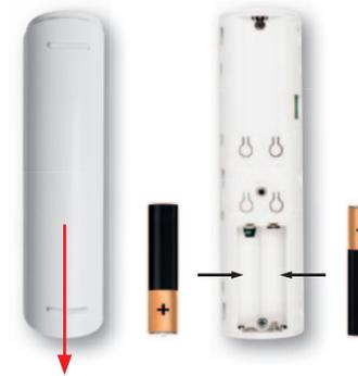
Um die Programmier Tasten und das Batteriefach zugänglich zu machen Rückseite des Handsenders nach unten schieben und abnehmen.
